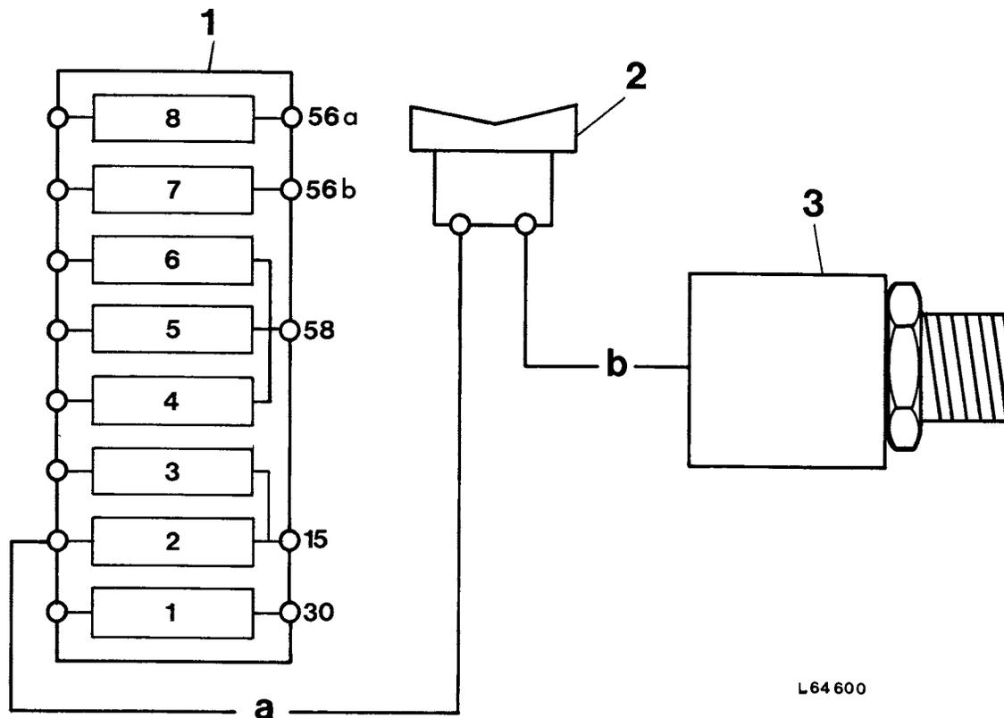
Fig. 5 — Wiring Diagram
