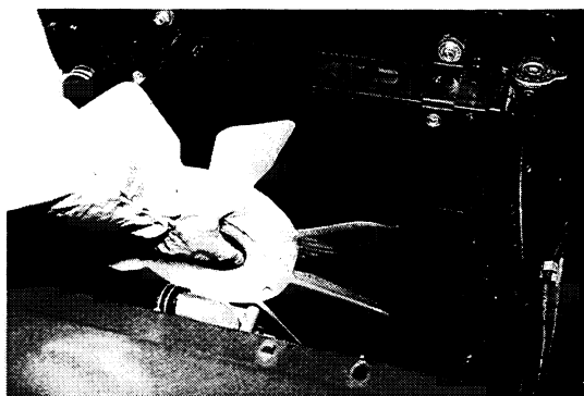
Removing the Fan
